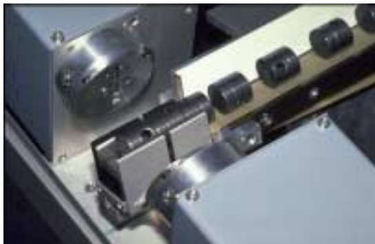
Fig. 5: Misura del diametro esterno di pistoncini per compressori, prodotti in passata. Uno speciale software di filtraggio consente di effettuare una misurazione immune dall'effetto della gola e del foro radiale.
