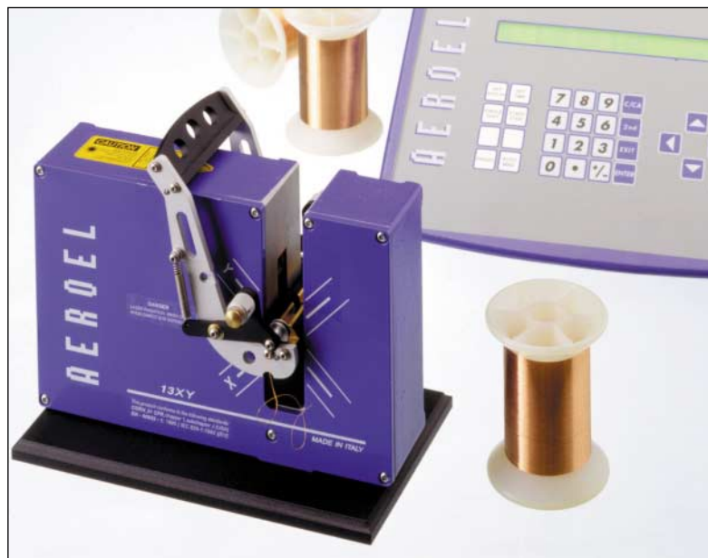
Fig. 15 - L'utilizzo del calibro laser per la misura del diametro e dell'ovalizzazione del filo campione trafilato si è dimostrato molto proficuo ed ha oramai soppiantato altri sistemi classici.
